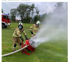
**Der Drucklüfter** wurde durch Gerätewart Gerhard Auer mit einem Sprühring ausgestattet. Dieser kann im Einsatzfall die Löscharbeiten enorm erleichtern.
