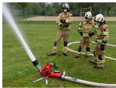
**Der Wasserwerfer im Einsatz:** Bis zu 3000 Liter Wasser pro Minute strömen aus diesem Gerät.
