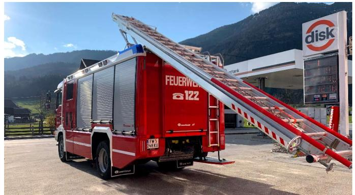
Leiterabsenkung für die 14 Meter lange Schiebeleiter
