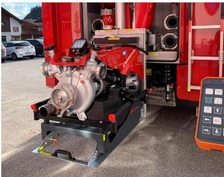
Tragkraftspritze - Feuerlöschpumpe
